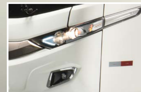
Conjunto óptico: faroles con nuevo diseño interno y DRL integrado.
